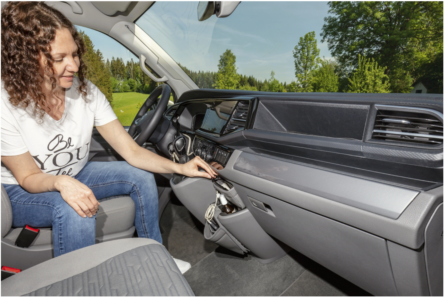
TIALO Box: Der praktische Ablageort für Brille, Papiertücher, Geldmünzen etc. – der Zigarettenanzünder muss abgezogen werden.
