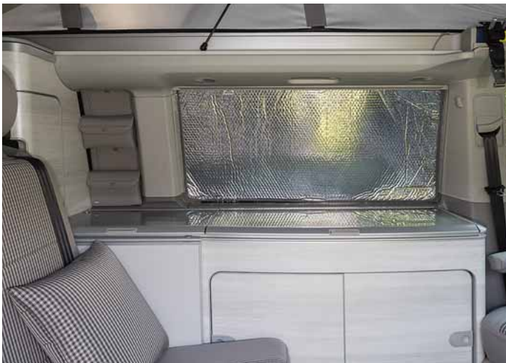
ISOLITE Inside für die einfachverglasten Fahrgastraumfenster links VW California Ocean/Coast und für die Fahrgastraumfenster rechts.
