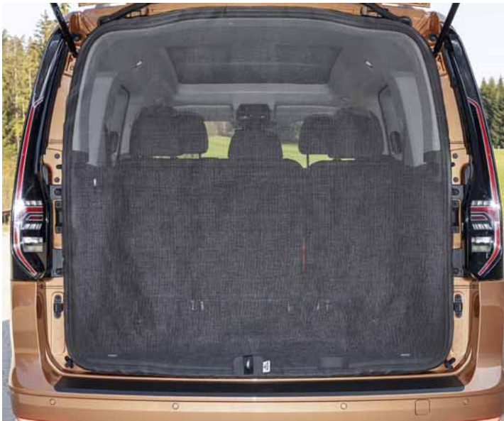
Das FLYOUT für die Heckklappe der VW Caddy 5 wird einfach mit Gummizug befestigt. Zusätzlich sorgen sieben Klettverschlussgurte für eine schnelle Anbringung und für einen guten Halt. Das FLYOUT lässt sich auf die Heckablage oder das Bett des Caddy California hochklappen, wenn die untere Ladefläche zugänglich sein soll. Das FLYOUT ist für die gleichzeitige Verwendung des AIR-SAFE ausgelegt – für eine gute Durchlüftung.
