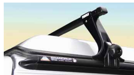
Fixation sûre et simple de galeries porte-bagages homologuées avec pieds de fixation pour gouttières pluviales. Vite enlevées pour ouvrir le toit.
