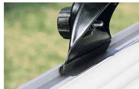
Le pied de la galerie s'emboîte bien dans le profilé de la gouttière. Pas de refoulement de l'eau de pluie qui continue à s'écouler normalement.
